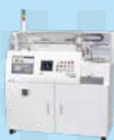
NAP-02 (球状黒鉛鋳鉄テストピースの自動切断・自動研磨及び球状化画像自動解析装置)
